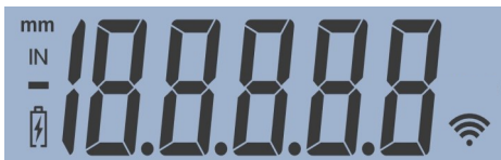
Fig.7, Affichage complet de tous les segments LCD
